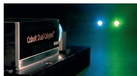
Bild 4: Links: Strahlprofil des Cobolt Dual Calypso. Der TEM 00 -Strahl mit >95% Rundheit enthält beide Wellenlängen. Oben: Die zwei Wellenlängen, separiert durch einen dichroitischen Spiegel
